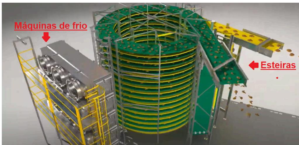
*Imagem 02 - Vista 1 Estrutura tecnológica de esteiras e máquinas de frio para IQF*
