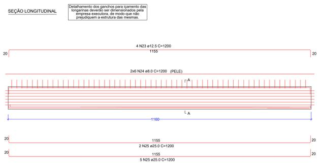
**Detalhamento da ferragem da laje**
