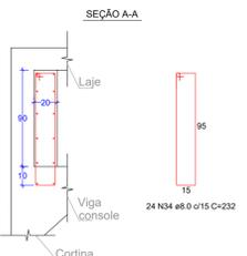
**Detalhamento das vigas de guarda rodas - 2 Vigas**
