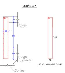
**Detalhamento das longarinas - L1=L2=L3=L4**
